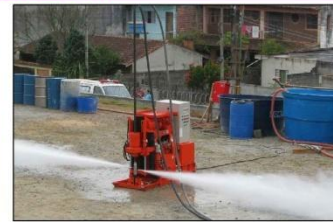
地上での高圧ジェット噴射テスト
